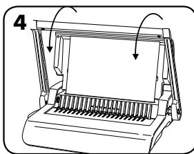
4. Perfore hojas a modo de prueba para verificar la configuración de la guía de bordes.
