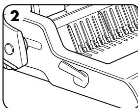
2. Insérez le peigne de plastique dans le mécanisme.
