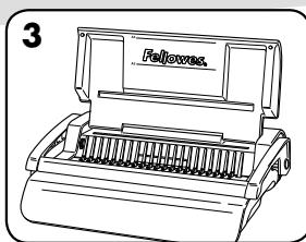
3. Levante la tapa. Asegúrese de que la palanca de apertura del peine esté colocada hacia atrás.
