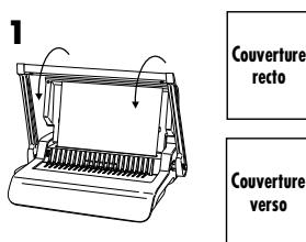
1. Perforez d'abord les couvertures avant et arrière.
