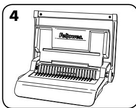
4. Coloque la manija de perforación en la posición vertical.
