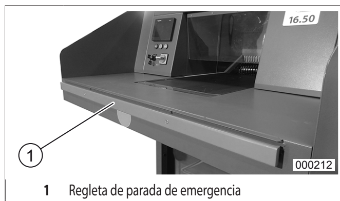
fig.3 Regleta de parada de emergencia
