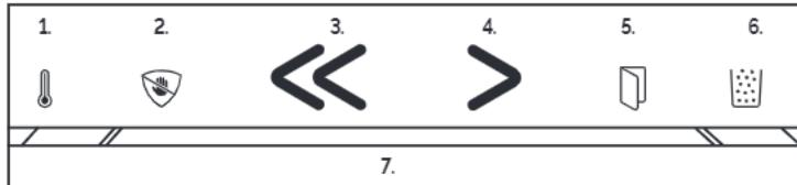
1. **Indicateur de durée de fonctionnement :** le voyant devient jaune lorsque la durée de fonctionnement maximale de la machine est presque atteinte et passe au rouge lorsqu'un refroidissement est nécessaire
