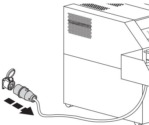
**DE** Bei der Reinigung Netzstecker ziehen!
