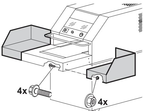
**DE** Seitentische an der Maschine befestigen.
