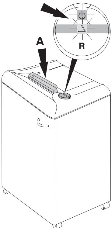
**NL** Automatische stop als de veiligheidsklep (A) geopend wordt (Symbolen  $\Delta$  en  $\odot$  knipperen afwisselend.)
